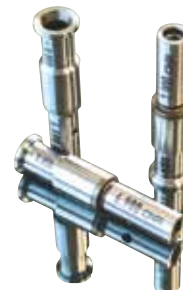
CNR Code : 150 - 226 Detroit Dizel Valf 6.980 - 7.025 Ara Ölçüm : 0.005 mm Tetikleme : 0.025 : 0.050
